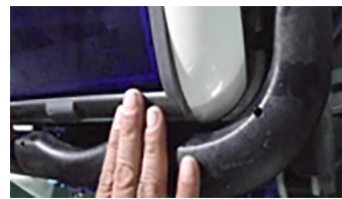
8. Druk op de twee uiteinden van de handgreep om met de robot te werken
